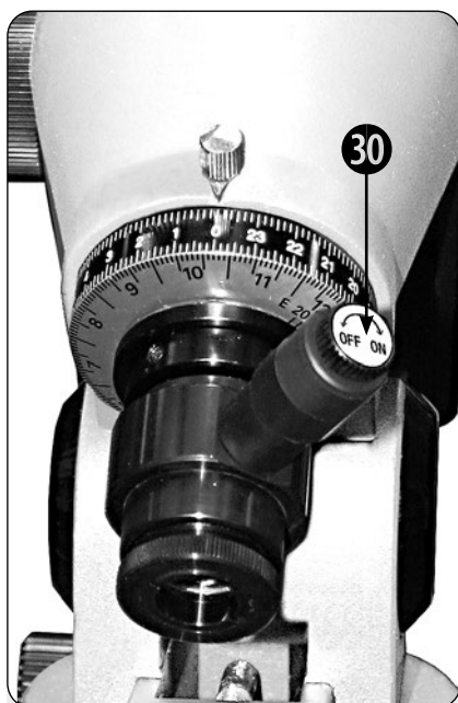
Obr. 37: Detail: polární hledáček s otočným knoflíkem (ON/OFF)
