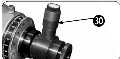
*Obr. 13 b: Před prvním použitím osvětlení vyjměte izolační podložku (viz obr. 13 a) z držáku baterií.
